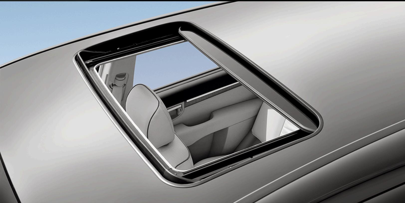
La línea de techos corredizos Hollandia 700, ofrece tres tamaños para adaptarse a casi cualquier vehículo. Están diseñados con calidad e innovación agregando mucho lujo tanto al interior como al exterior del vehículo. El vidrio del techo corredizo se inclina o se abre con tan sólo tocar un botón.
